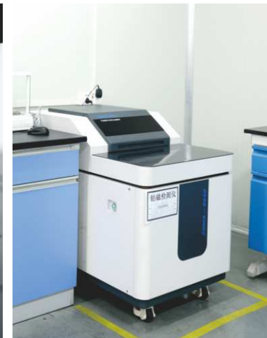
比饱和和磁化强度测量仪
